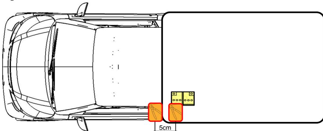
Trennen Sie mit geeignetem Werkzeug ein etwa 5 Zentimeter langes Stück aus der Masseleitung der 12 Volt Batterie (Braun) aus. Trennen Sie so nahe wie möglich am Minus (-) Pol ein Stück der Masseleitung raus, oder nehmen Sie den Minus-Pol ab und isolieren diesen von der Fahrzeugmasse.
