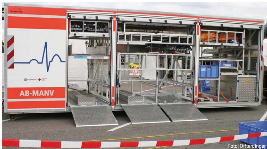
Abb. 2: In einem Abrollbehälter MANV (hier: Standort Stuttgart) ist medizinisches und technisches Material für den Aufbau und den Betrieb eines Behandlungsplatzes für mindestens 25 Patienten bei einem Massenanfall von Verletzten oder Erkrankten (MANV) untergebracht
